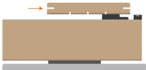
Figur 3: Monter brættet på underkonstruktionen, og skub læberne ind i holderne.
