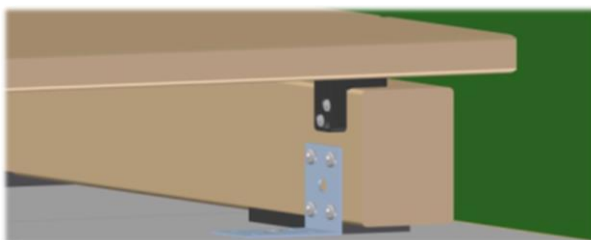
Figur 8: Skru endeclipsen fast til underkonstruktionen
